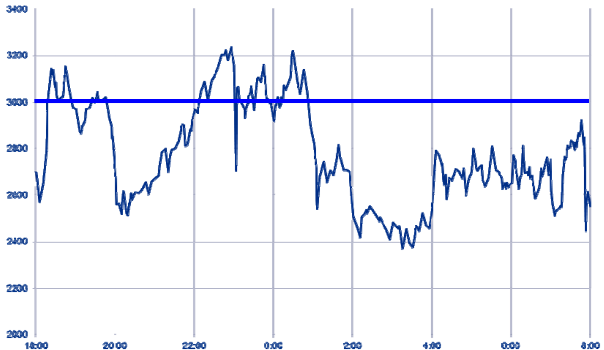
Abbildung 23: Ausfallrechnung einer Freileitung (Leitung 413) nach Redispatch und netzbezogenen Maßnahmen auf der Trasse Remptendorf-Redwitz für die Nacht vom 22. auf den 23. Februar 2012. Die Berechnung zeigt zeitweise deutliche Überschreitungen der Nennbelastbarkeit von 3000 A auf dem verbleibenden Leitungsabschnitt (Leitung 414). Quelle: ÜNB.
