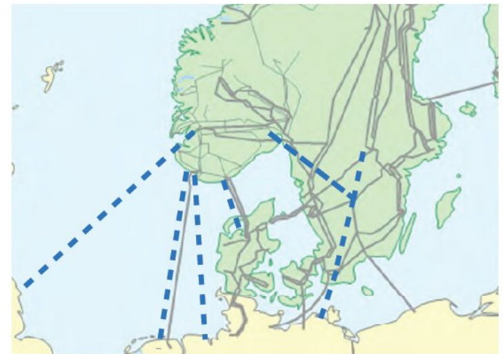
FIGUR 10.2: Potensielle nye udenlandsforbindelser. Fra Statnetts Nettutviklingsplan 2010
